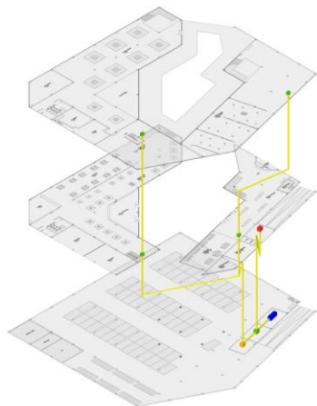
Gambar 5.4 Isometri Sistem Utilitas Listrik Sumber: Dokumentasi Pribadi
