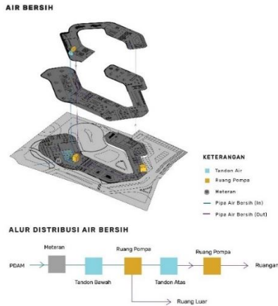
Gambar 5.3. Sistem Utilitas Air Bersih
