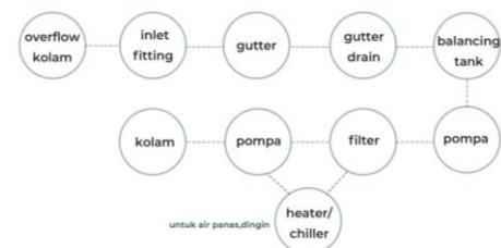
Gambar 5.3 Diagram Sistem Overflow Kolam Sumber: Dokumentasi Pribadi
