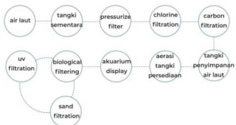
Gambar 5.5 Diagram Sistem Air Bersih Akuarium Sumber: Dokumentasi Pribadi
