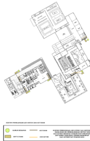
Gambar 2.13 Sistem Utilitas Air Kotor dan Kotoran
