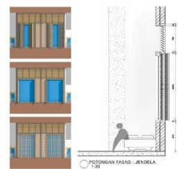
Gambar 3.8 Tampak dan Potongan Jendela
