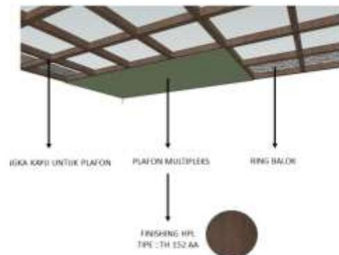
Gambar 3.4 Detail pemasangan plafon
