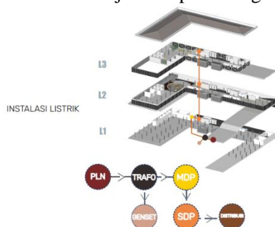
Gambar 5.3. Sistem utilitas listrik
