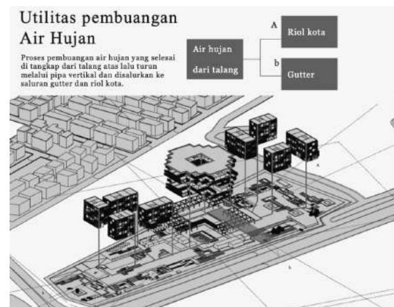
Gambar 2.3 Utilitas pembuangan air hujan
