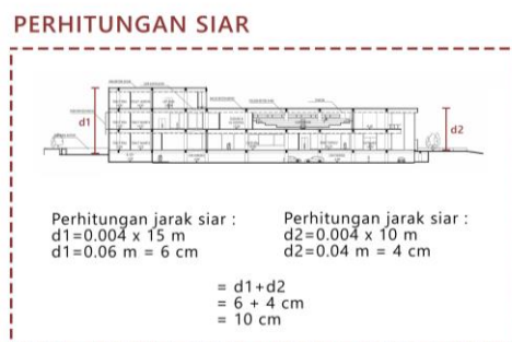
Gambar 4.4. Perhitungan siar. Sumber : dokumentasi pribadi.
