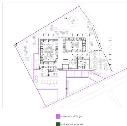
Gambar 5.3. Utilitas Air Hujan dan Sampah
