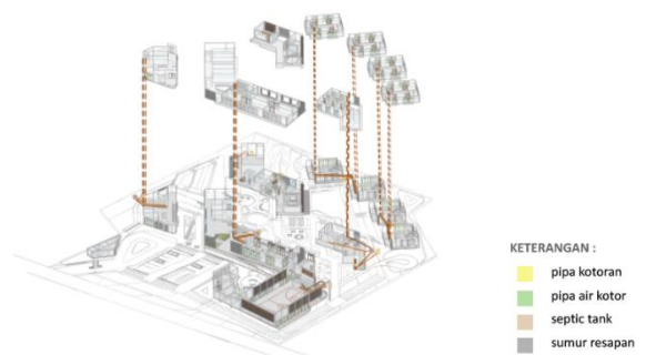
Gambar 5.2 Sistem Utilitas Air Kotor dan Kotoran
