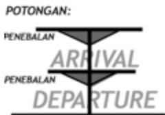
Pada bagian bangunan yang cenderung lebih pipih dan memanjang, digunakan single kolom dengan konsol ke kedua sisinya. Prinsip penyaluran beban ke pondasi, seperti huruf Y. Beban yang diterima balok akan disalurkan ke kolom ditengah sehingga dibutuhkan penebalan pada sudut pertemuan kolom dan balok, untuk memperkuat.
