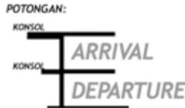
Pada banyak bagian sisi terluar bangunan ini, banyak terdapat sosoran yang disanggah menggunakan konsol jepit satu sisi (sisi lainnya bebas). Balok - balok inilah yang berperan sebagai konsol, sehingga balok harus diperkuat dengan cara mempertebal ketinggian balok, sehingga tinggi balok konsol menjadi lebih besar daripada balok lantai normal.
