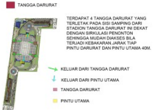
Gambar. 2.12 Sistem Utilitas Kebakaran.
