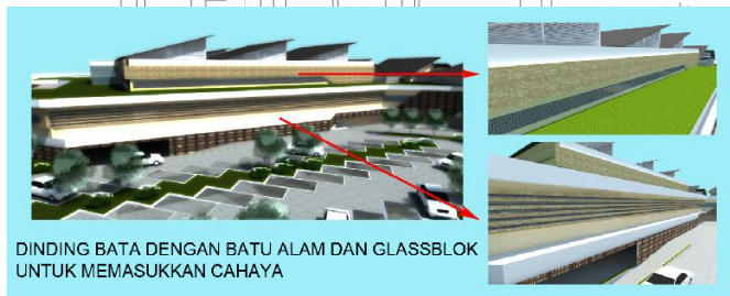
Gambar.2.8. Sisi Dinding yang Menghadap Sumber Kebisingan
