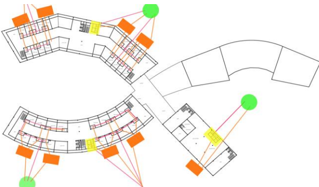
Gambar 33. Utilitas Air Kotor dan Kotoran pada Lantai 2 dan 3
