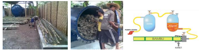
Gambar 26. Dari Kiri: Sistem Pengawetan Konvensional, Sistem Vertical Soak Diffusion, Dan Teknik Boucherie Sumber: Google Images
