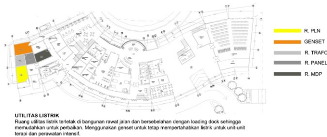
Gambar. 2.18 Sistem Utilitas Listrik
