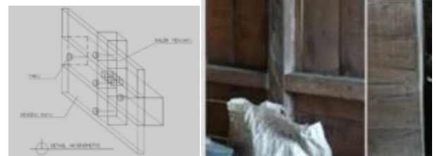
Gambar 2.23 Kiri : pengaplikasian detail sambungan bangunan cottage; Kanan : detail sambungan pada bangunan Pu'u Sumber : Kiri : data pribadi ; Kanan :googleimages.
