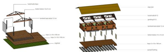
Gambar 2.19. Isometri struktur hotel cottage dan cottage
