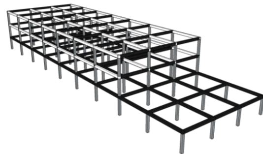
Gambar 3.6. Sistem struktur rangka konstruksi beton bertulang.
