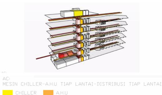
Gambar 5.4. Isometri sistem ac
