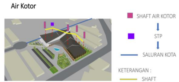
Gambar 2. 21. Sistem utilitas air kotor
