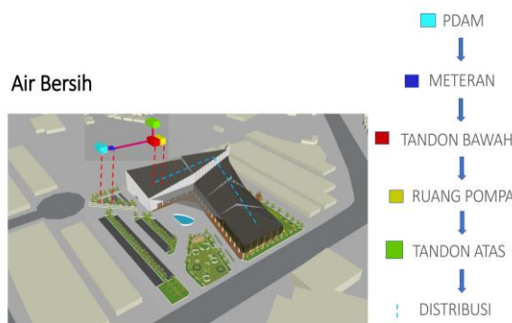
Gambar 2.20. Sistem utilitas air bersih
