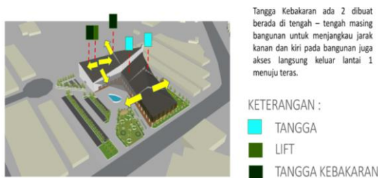
Gambar 2. 25. Sistem utilitas vertikal
