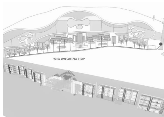
Gambar 5.3 Utilitas Air kotor
