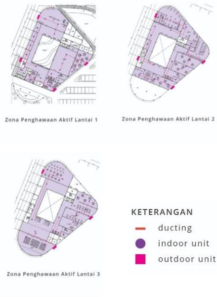
Gambar 5.4. Isometri sistem tata udara
