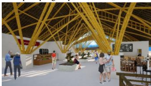
Gambar 2.2.1 Bambu sebagai Elemen Struktur Atap
