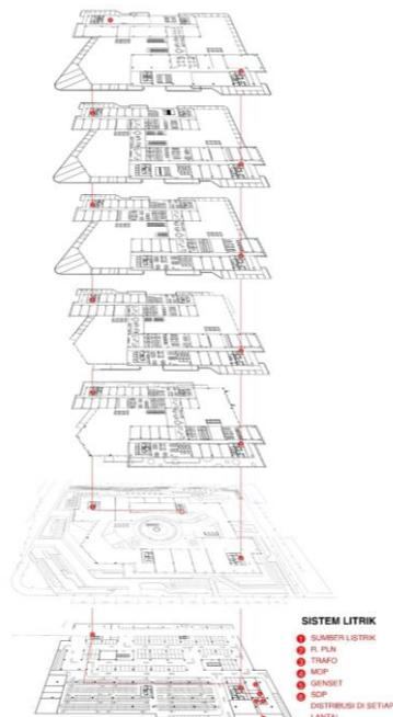
Gambar 6.2 Diagram sistem utilitas listrik
