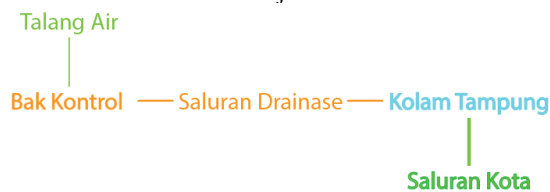
Gambar 4. 4. Gambar denah bak kontrol dan saluran air hujan.
