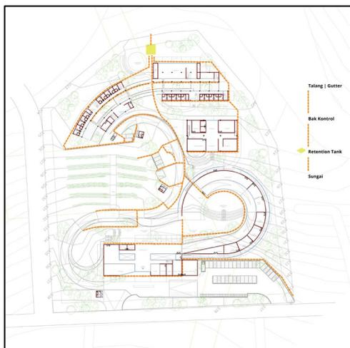
Gambar 5.3 Diagram pengaliran air hujan
