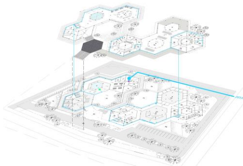
Gambar 5.1. Isometri utilitas air bersih
