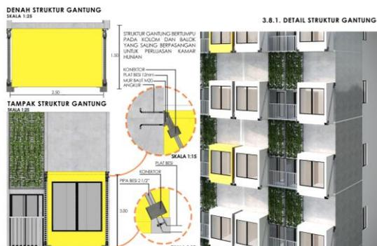
Gambar 2.12 Detail Struktur Gantung
