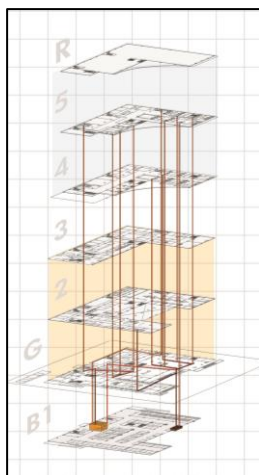
Gambar 5.3. Isometri utilitas kotoran
