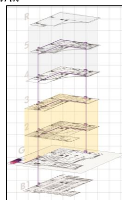
Gambar 5.6. Isometri utilitas air bersih
