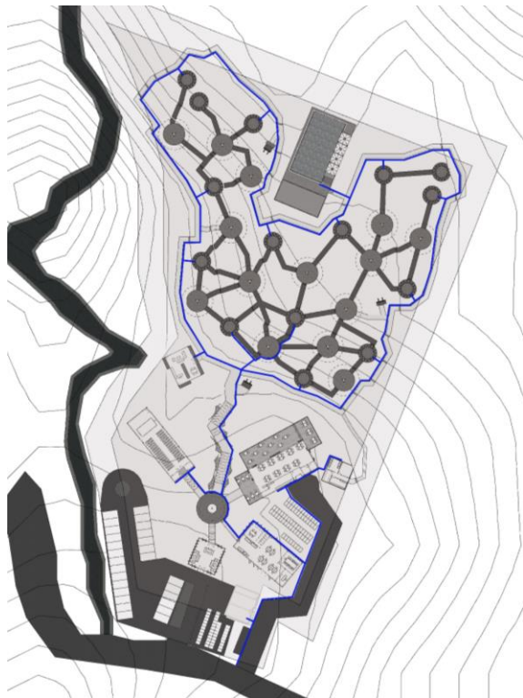
Gambar 4.1. Utilitas Air Bersih
