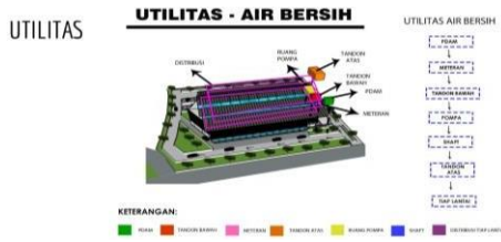
Gambar 2.21. Sistem utilitas air bersih
