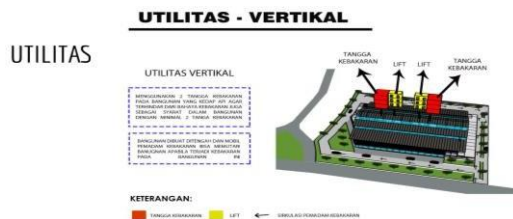
Gambar 2. 23. Sistem utilitas vertikal
