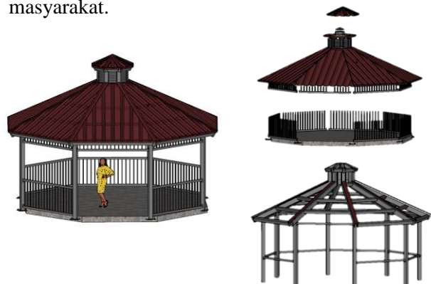
Gambar 5.1 Detail Struktur Gazebo
