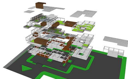
Gambar 4. 3. Gambar perspektif struktur bangunan.
