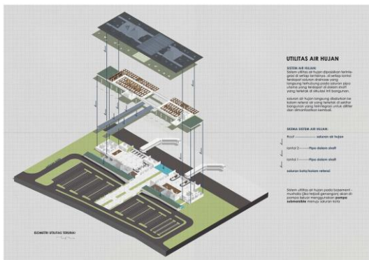
Gambar 2.21. Skema utilitas air hujan
