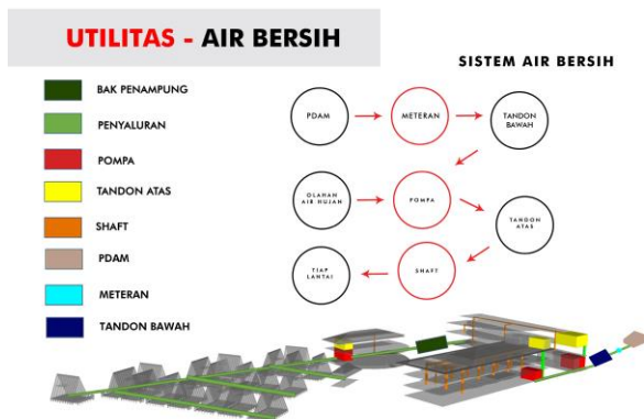
Gambar 2.20. Sistem Utilitas Air Bersih
