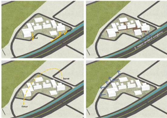
Gambar 2.3. (Dari kiri-kanan, atas-bawah) akses masuk, orientasi bangunan terhadap jalan, orientasi bangunan terhadap matahari, view
