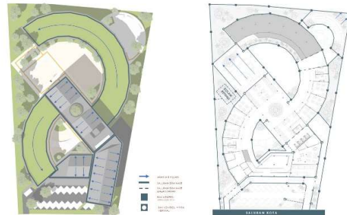
Gambar 3.17 Sistem Utilitas Air Hujan.
