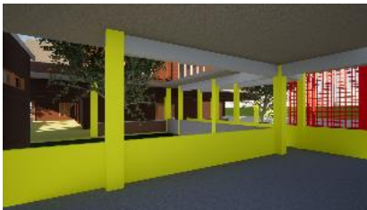
Gambar 2.12. Warna kolom & railing menuju hunian lansia tahap mild dan detail lighting pada selasar
