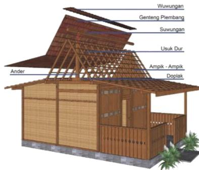
**GAMBAR 3.6.1** Struktur atap *Omah Osing* (sumber : Bappeda, 2020)
