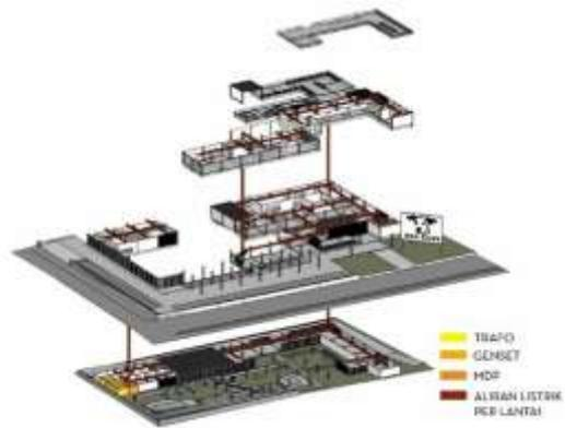
Gambar 2. 30. Isometri aliran listrik.
