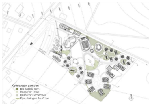
Gambar 2.14 Sistem utilitas air kotor
