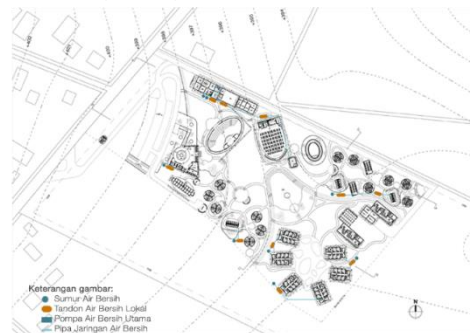
Gambar 2.12 Sistem utilitas air bersih
