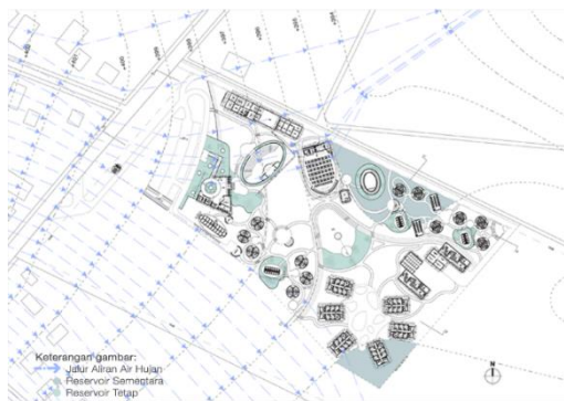
Gambar 2.13 Sistem utilitas air hujan
