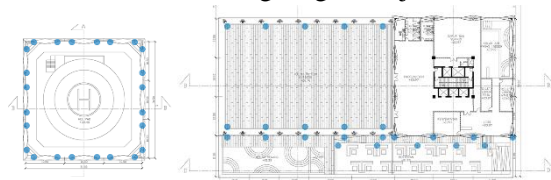
Gambar 2.13. Utilitas air hujan (letak afur)
