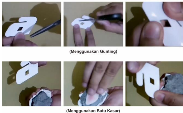
Gambar 1.4. Uji coba ketahanan gesekan
