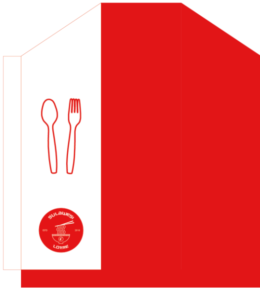
Gambar 21. Pola jejing pembungkus sendok dan garpu
