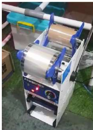
Gambar 8. Lampu Indikator Panas yang Diinginkan, Siap Disegel
