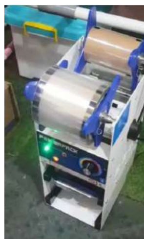
Gambar 7. Lampu Indikator Memanaskan, Belum Siap Segel
