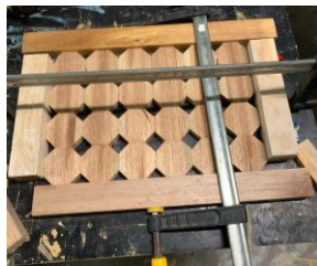
Gambar.8. proses penempelan motif wallpanel
