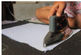
Gambar 10. proses pemasangan trikot pada kain serat pisang
