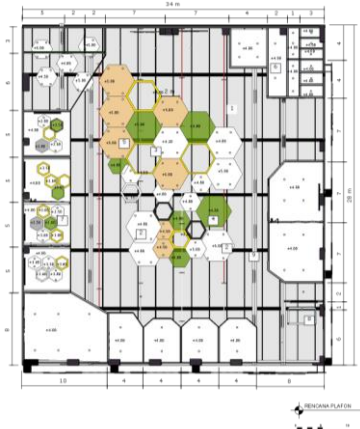
Gambar. 20. Rencana pola plafon (Gambar: Penulis,2019)
